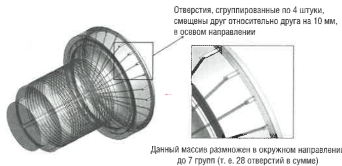
Рис. 4. Схема трассировки измерительных каналов по ротору компрессора
