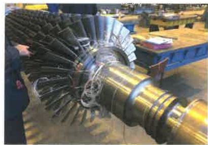
Рис. 5. Подготовка ротора компрессора к тензометрированию
