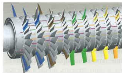
Рис. 4. Схема трассировки измерительных каналов по ротору компрессора
