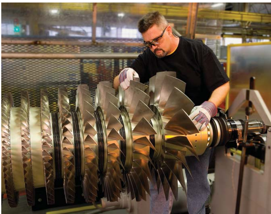
Сборка ротора газовой турбины Т25
