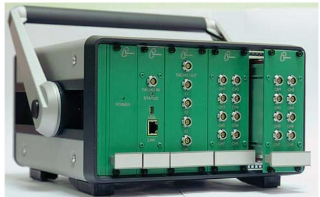
Фото 4. Портативный измеритель вибрации многоканальный СТД-1410
