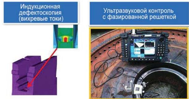
Рис. 10, 11. Дополнительные усовершенствованные методы контроля в рамках программы увеличения ресурса газовой турбины
