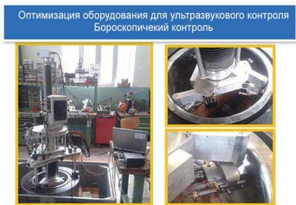
Рис. 12. Дополнительные усовершенствованные методы контроля в рамках программы по увеличению ресурса газовой турбины
