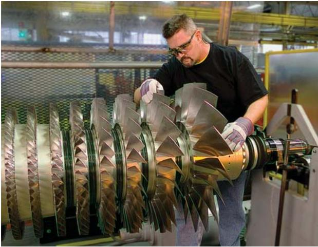
Фото 2. Балансировка ротора компрессора газотурбинного двигателя Т25 на площадке «РЭП Холдинга»
