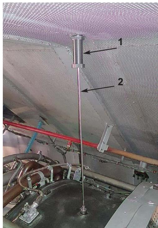
Фото 2. Подсоединение измерительного зонда к кожуху камеры сгорания
