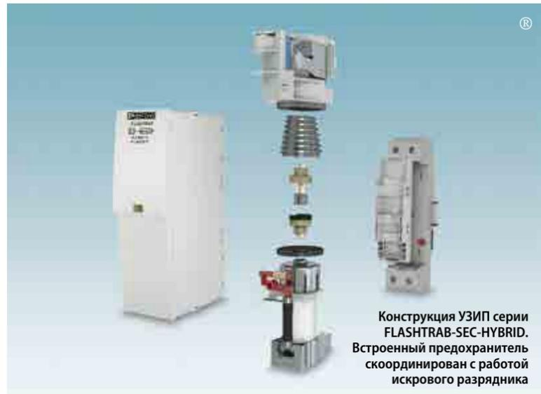
Конструкция УЗИП серии FLASHTRAB-SEC-HYBRID. Встроенный предохранитель скоординирован с работой искрового разрядника
