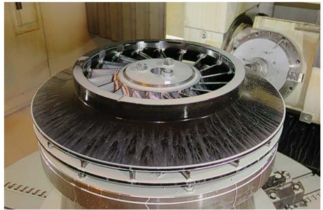
Фото 3. Цельнофрезерованное осерадиальное рабочее колесо
