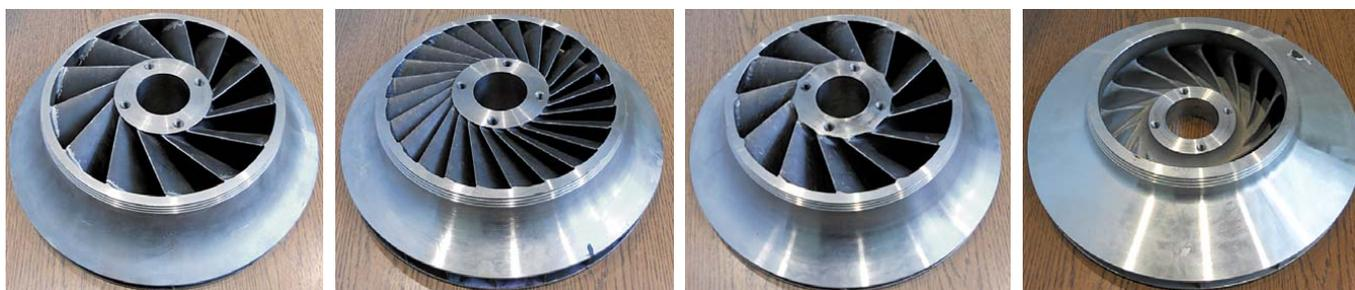
Рис. 3. Модельные осерадialные рабочие колеса с пространственными лопатками
