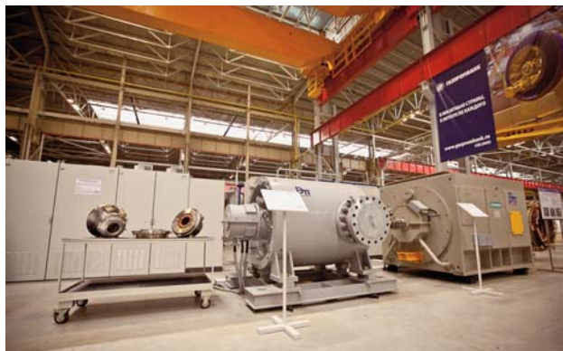
Фото 2. Электроприводный ГПА на производственной площадке Невского завода
