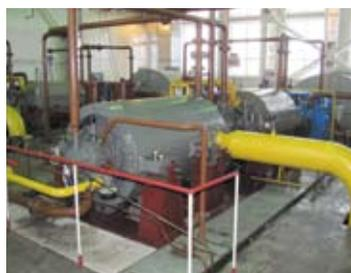
Компрессор К-320-131-1 производства ЗАО «РЭП Холдинг» предназначен для сжатия попутного нефтяного газа, поступающего с нефтяных скважин, и транспортировки его на газоперерабатывающий завод. Производительность
