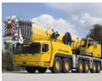
На рынке грузоподъемной техники появился вседорожный кран на автомобильном шасси GROVE GMK 6300-L грузоподъемностью 300 тонн. Высокая проходимость и управляемость GMK 6300-L обеспечиваются
