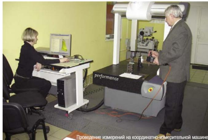
Проведение измерений на координатно-измерительной машине
