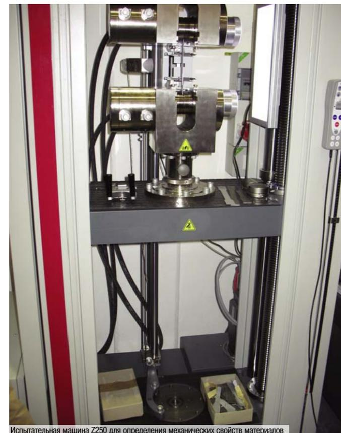
Испытательная машина Z250 для определения механических свойств материалов
