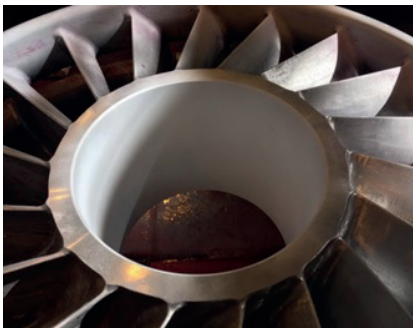
Рис. 7. Рабочее колесо после цветной дефектоскопии ЦБК K905-71-1С
