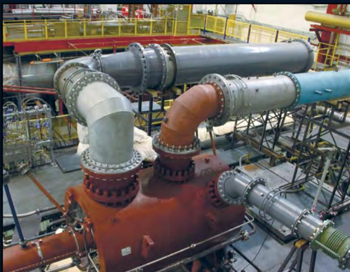
Компрессор смешанного хладагента успешно прошел испытания на Невском заводе, подтвердив предусмотренные контрактом технические характеристики. «РЭП Холдинг» стал первым в России и третьим в мире производителем компрессорного оборудования данного типа.
