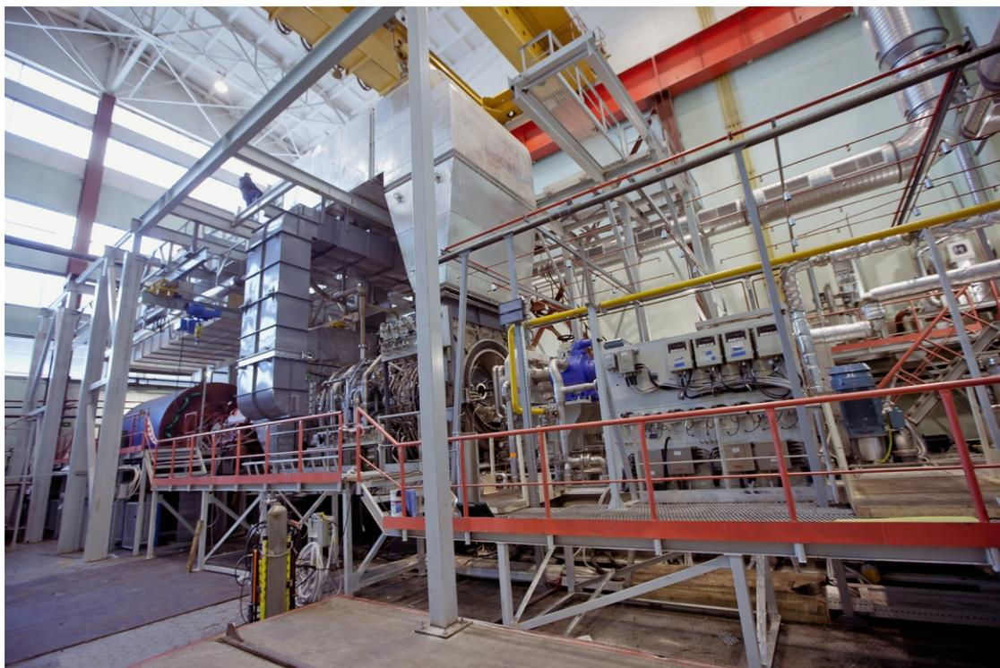
На Невском заводе обрудован высокотехнологичный испытательный стенд для выполнения механических, теплотехнических и исследовательских испытаний газотурбинных установок с целью комплексной проверки готовности ГТУ к отгрузке и эксплуатации.
