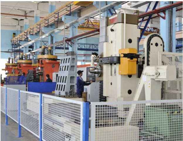
5-осевой обрабатывающий центр Mori Seiki NT4200DCG/1500S
