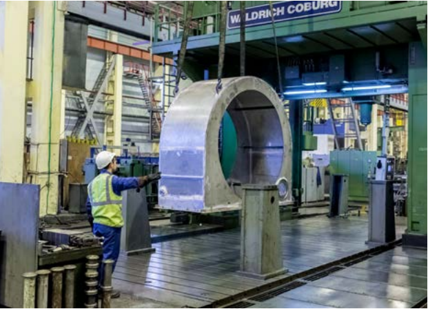
Портально-фрезерный станок W. Coburg 20-10GM360NC
