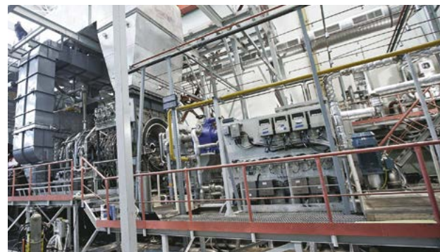
Испытательный стенд газовых турбин мощностью 32 МВт
