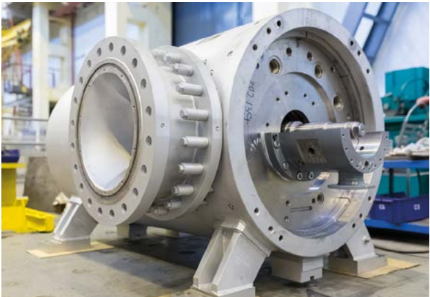
Унифицированный корпус ЦБК для Т25
