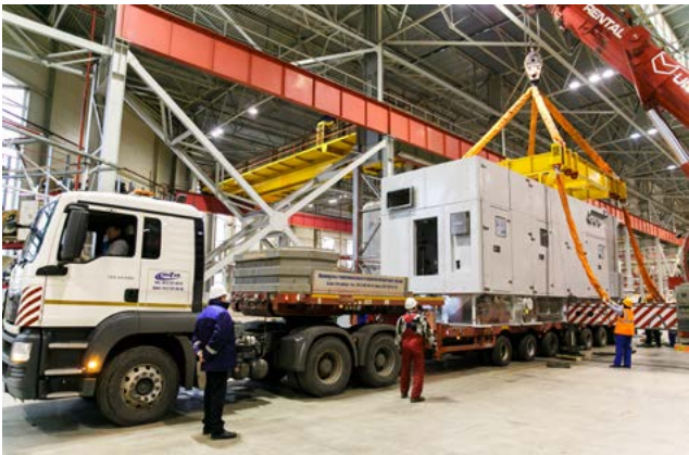
Транспортировка ГТУ Т16 в состоянии полной заводской готовности
