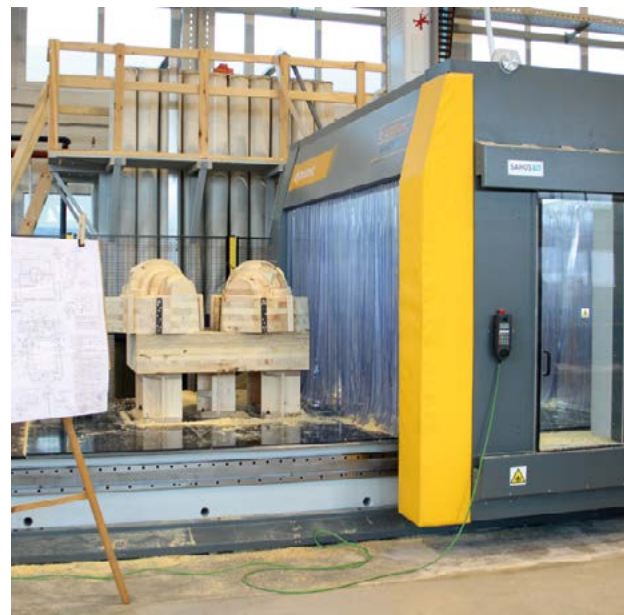
Пятикоординатный станок Dinamic FC 4000 спс для изготовления моделей
