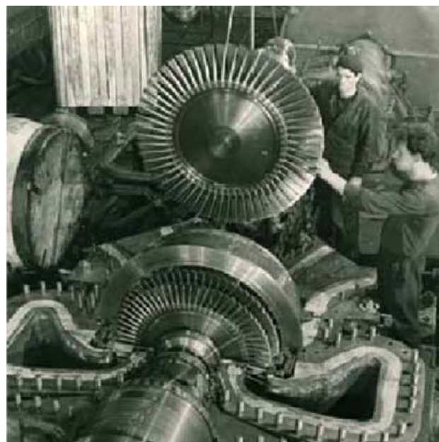
Изготовление паровой турбины
