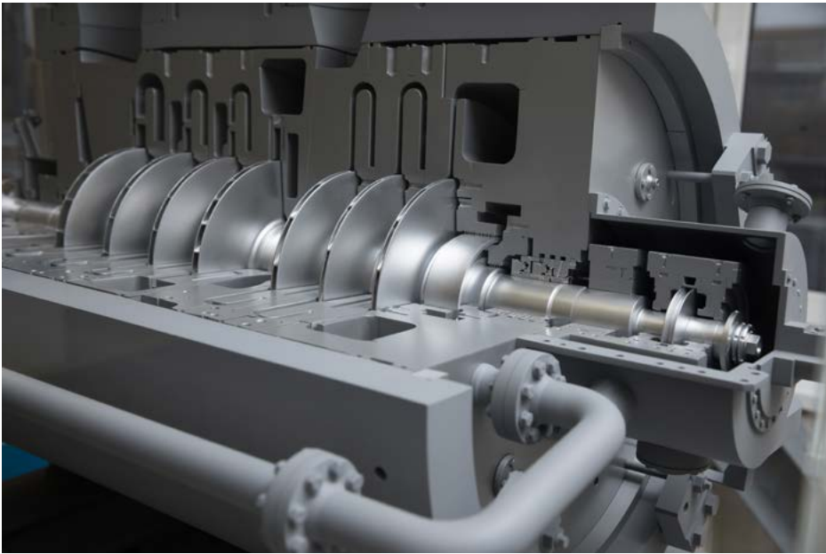
Элемент макета компрессора K905-71-1C
