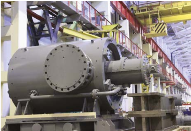
Унифицированный центробежный компрессор 405-21-1С
