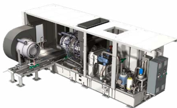
Боковая выкатка силовой турбины из-под кожуха
