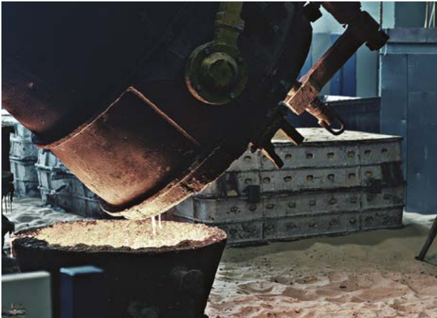
Разливка металла на плавильно-заливочном участке «Невского завода»
