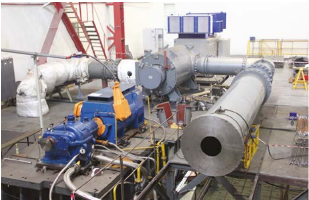
295 СПЧ 3.0 на испытательном стенде Невского завода
