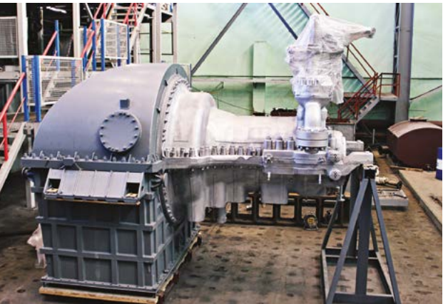
Паровая турбина К-22-90-2М
