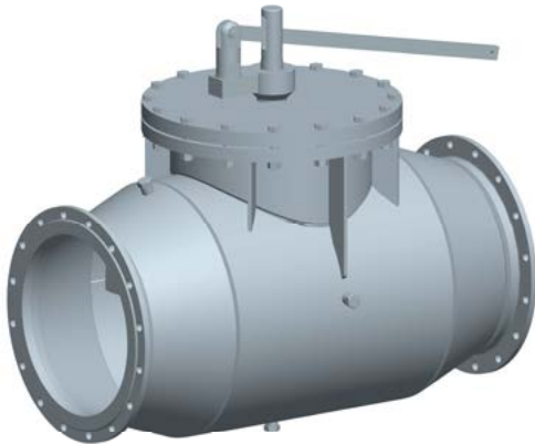
3D-модель атмосферного клапана
