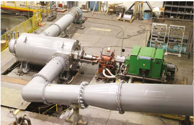
СПЧ на испытательном стенде Невского завода
