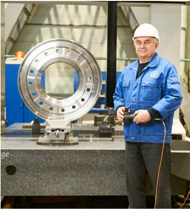
Проведение измерений на координатно-измерительной машине
