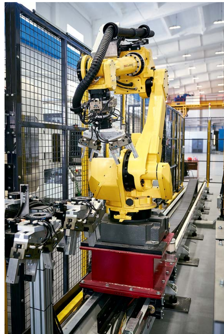
1/ Роботизированный комплекс Unica по изготовлению компрессорных лопаток
